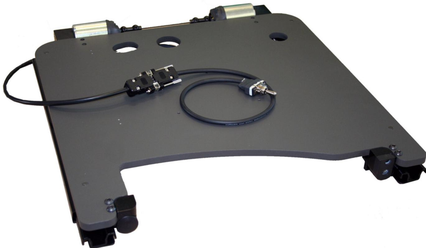
La base traslante è un ausilio al trasporto che facilita la salita e discesa dal veicolo da parte di persone con ridotte capacità motorie, aumentando la corsa del sedile di 22 cm.
