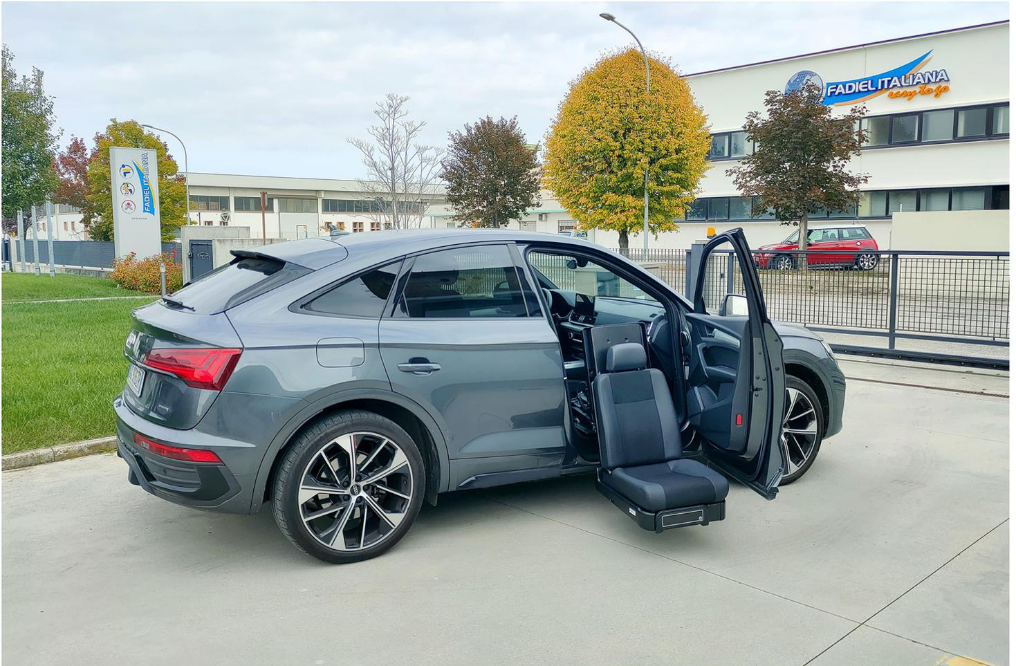
Il sedile girevole uscente **C400** è un sistema automatico che facilita l'accesso al veicolo a persone disabili con ridotte o impedito capacità motorie e per le persone anziane con difficoltà ad effettuare movimenti di salita e discesa dall'auto.
