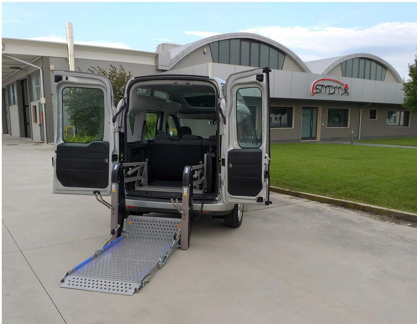
Novità assoluta in casa Fadiel Italiana, il **Sollevatore per carrozzine a doppio braccio elettro idraulico, azionato da operatore, a piattaforma piana pieghevole con movimentazione automatica**
